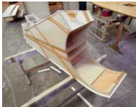
Der auf 150 Grad Celsius erhitzte Mineralwerkstoff wird auf der Schablone in Form gebracht
