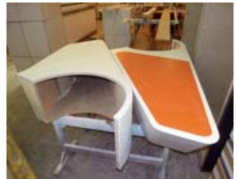
Für die Endmontage vorgefertigt: Die beiden aus der Säule auskragenden Elemente
